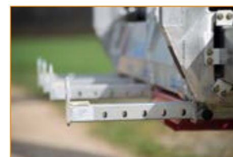
Oben: Ruthmann Lifting-Eye-System LES 100 ist ideal für die beschädigungsfreie und sichere Montage von Mobilfunkantennen der neuesten G5-Generation.
