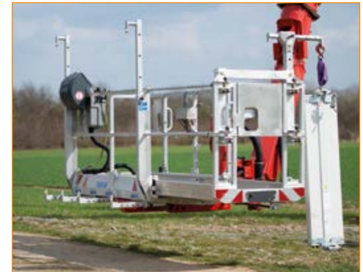
Links: das Ruthmann Lifting-Eye-System LES 100 erlaubt durch die vier möglichen Montagepunkte am Arbeitskorb z. B. auch die Montage von Bauteilen hinter Störkanten.
