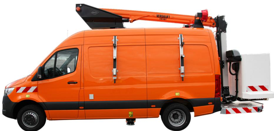
■ Länge: 7,405 mm    ■ Höhe: 3,580 mm    ■ Radstand: 3,665 mm
