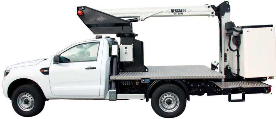
■ Länge: 6,625 mm    ■ Höhe: 2,555 mm    ■ Radstand: 3,220 mm
