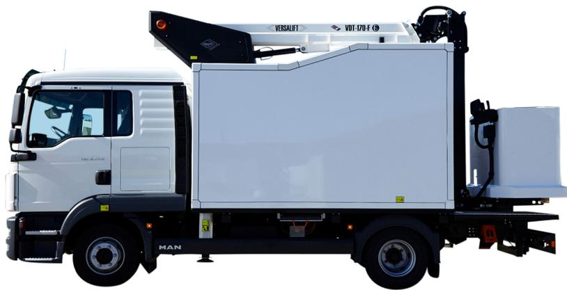
■ Länge: 7,085 mm    ■ Höhe: 3,650 mm    ■ Radstand: 3,600 mm
