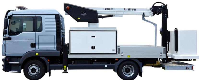
■ Länge: 7,730 mm    ■ Höhe: 3,200 mm    ■ Radstand: 3,600 mm
