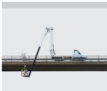
Kann bis 3,3 m unterhalb des Fahrzeugniveaus arbeiten
