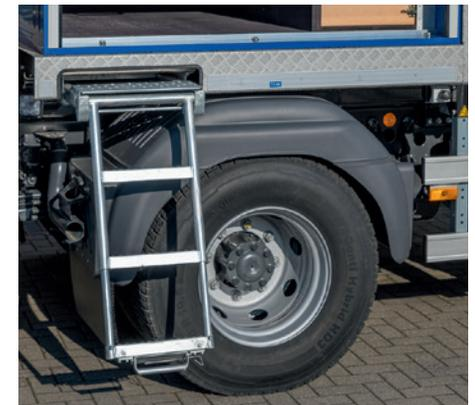
Der Kofferaufbau kann mit der optionalen, ausziehbaren Leiter bequem beladen werden.
