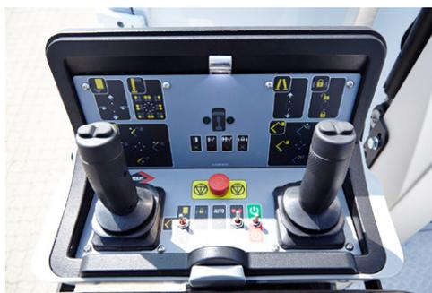
Lastmoment-Steuerung: Variable Reichweite und bis zu 2 gleichzeitige Bewegungen (1 per Joystick)
