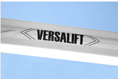
Die geformten Ausleger aus hochfestem Stahl der VTL verfügen über eine verbesserte Festigkeit und Steifigkeit
