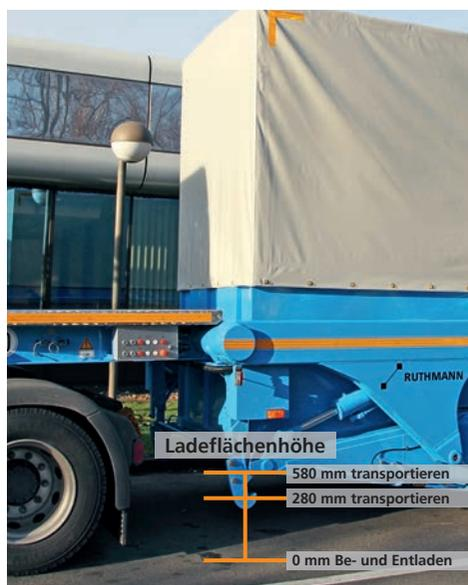
Mit den CARGO LOADER® TRAILER'n **RCPT 140/155** bietet **RUTHMANN** der Transportbranche einen **außergewöhnlich effektiven Sattelaufleger**. Besonders nützlich ist der Aufleger, wenn **auf kurzen Fahrstrecken häufig schwere Güter be- und entladen** werden müssen.
