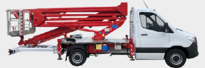
Mit der ECOLINE RS 240 können herausragende **24 Meter Arbeitshöhe** erreicht werden. Die Gelenk-Teleskop-Bühne bietet in der „**low budget**“- Angebotsreihe enorme Anwendungsflexibilität und -möglichkeiten. Seit Einführung im Frühjahr 2017 erfreut sie sich großer Beliebtheit und ist europaweit im Einsatz.
